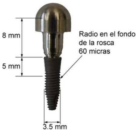
Figura 3. Geometría del implante ensayado.
