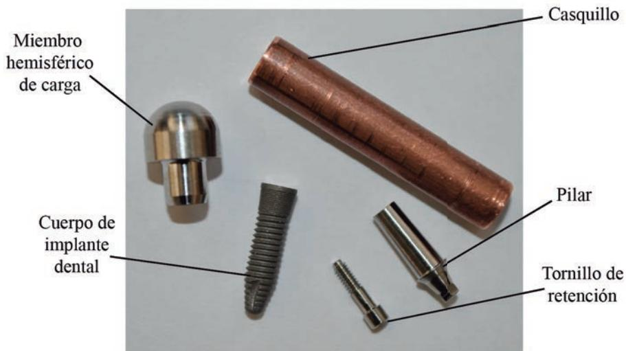
Figura 3.16: Componentes del modelo de EF del sistema de implante dental ICI
